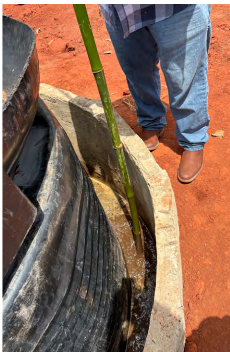
Figure 58 - Remuer le matériau à l'aide d'un bâton afin de favoriser la production de biogaz.
