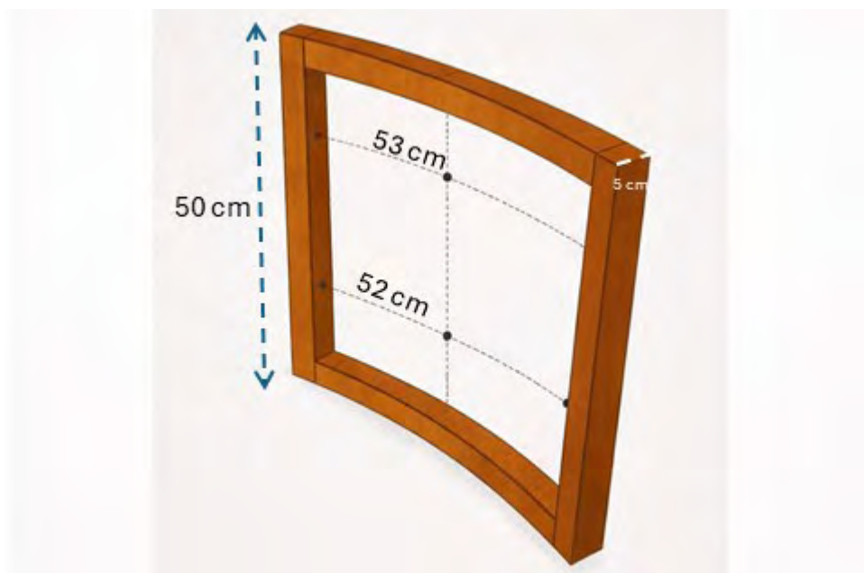
Figure 4 - Schéma de moule pour la fabrication des plaques.
