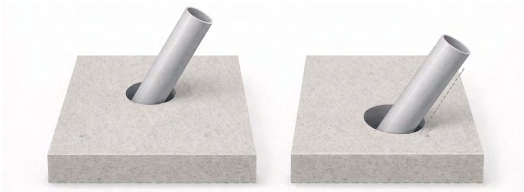
Figure 7 - Schéma illustratif du perçage des trous dans deux plaques, à un angle de 45°. Une plaque avec un trou au centre, une autre avec un trou à l'extrémité gauche.
