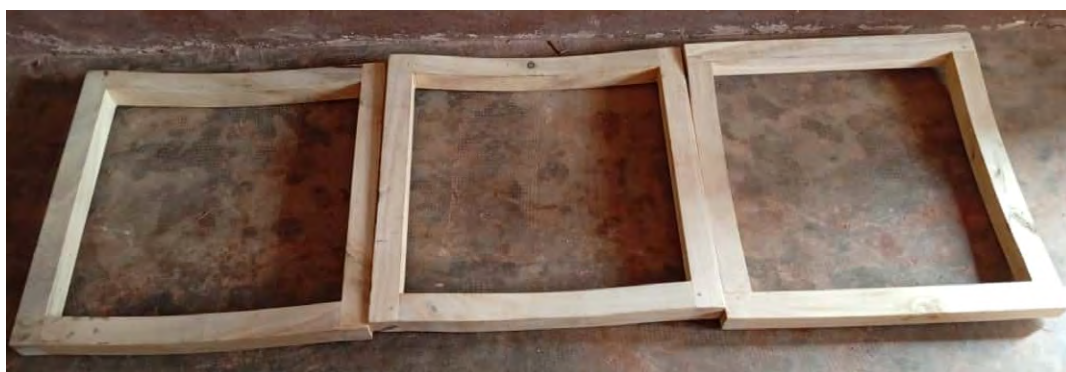
Figure 5 - Moules prêts pour la fabrication des plaques.
