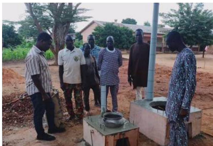
Figure 24 - Foyers de dimensions différentes, adaptés à des marmites de tailles variées, en cours de séchage. Les cheminées ont des dimensions différentes, conçues en fonction du lieu d'utilisation des foyers ou de la disponibilité des matériaux.
