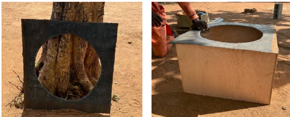
Figure 17 - Découpe du couvercle pour l'ouverture du foyer. Base des moules placés sur trois foyers
