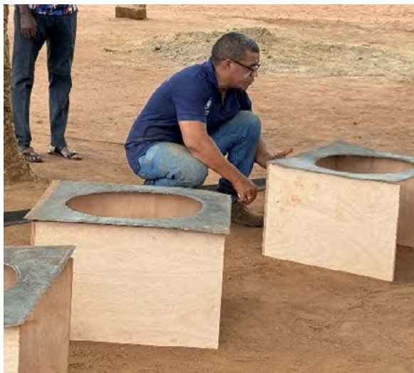
Figure 18 - Moules pour trois foyers avec plaque de zinc, déjà avec les ouvertures découpées.
